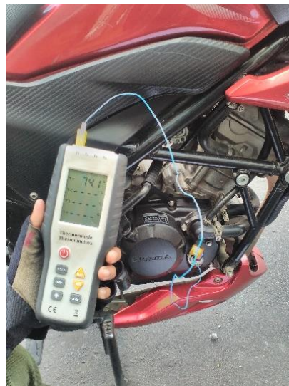
Gambar 3.48 Pengukuran temperatur minyak pelumas
