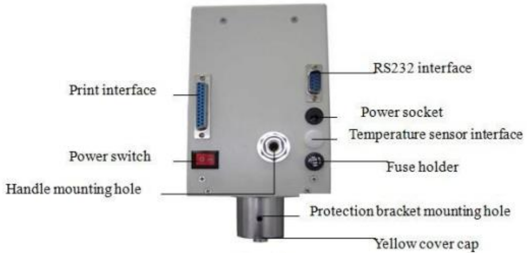
Gambar 3.9 Bagian kepala viscometer NDJ-8S
