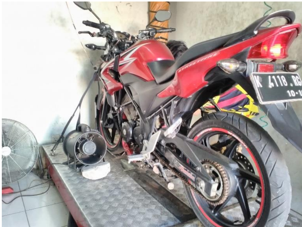
Gambar 3.44 Posisi sepeda motor di atas roller dynotest
