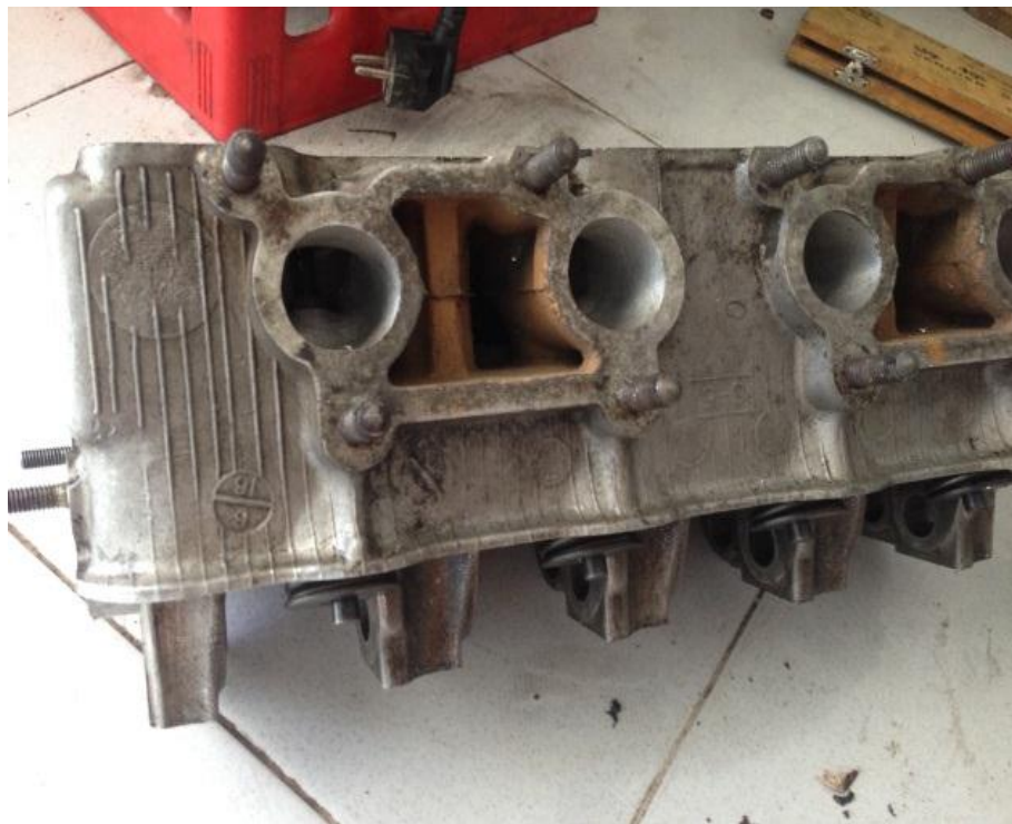
Porting Polish pada lubang Intake
