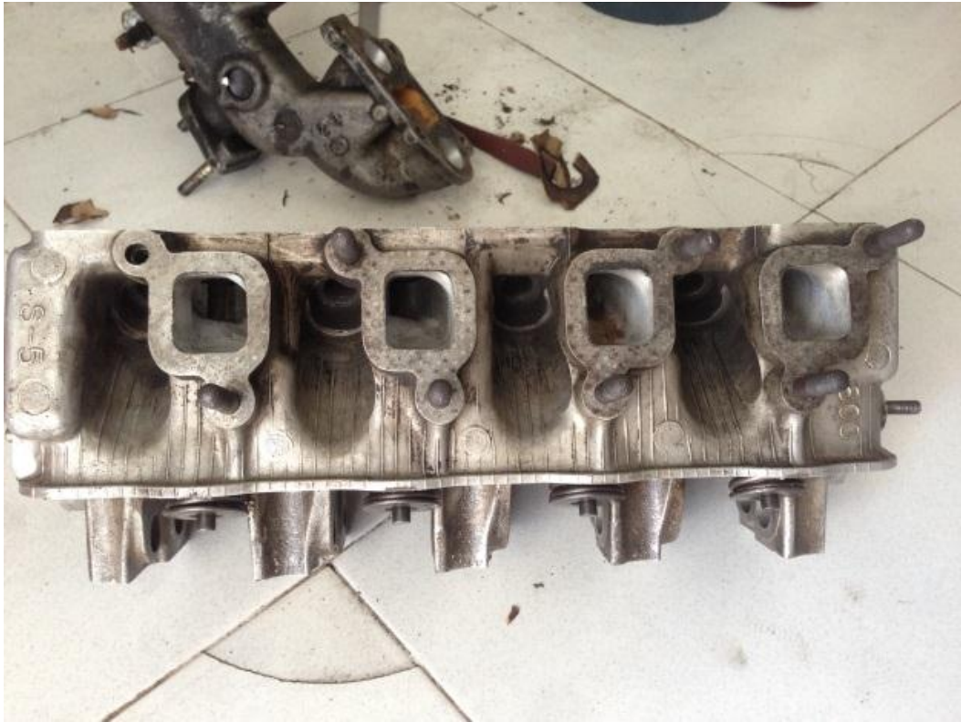
Porting Polish pada lubang Exhaust
