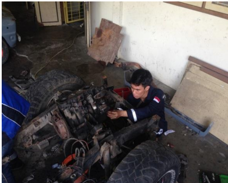
Pelepasan mesin dari Engine bay
