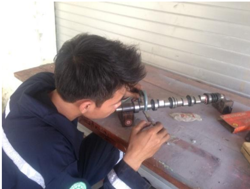
Proses Perhitungan Jurnal camshaft dan Tonjolan
