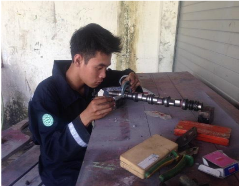
Proses Perhitungan Jurnal camshaft dan Tonjolan
