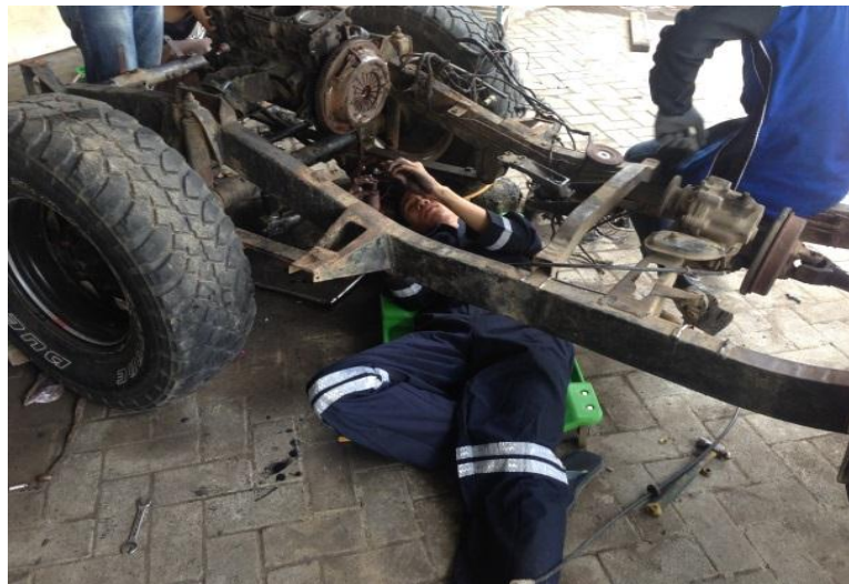
Gambar 4.2 Proses pembongkaran head.
