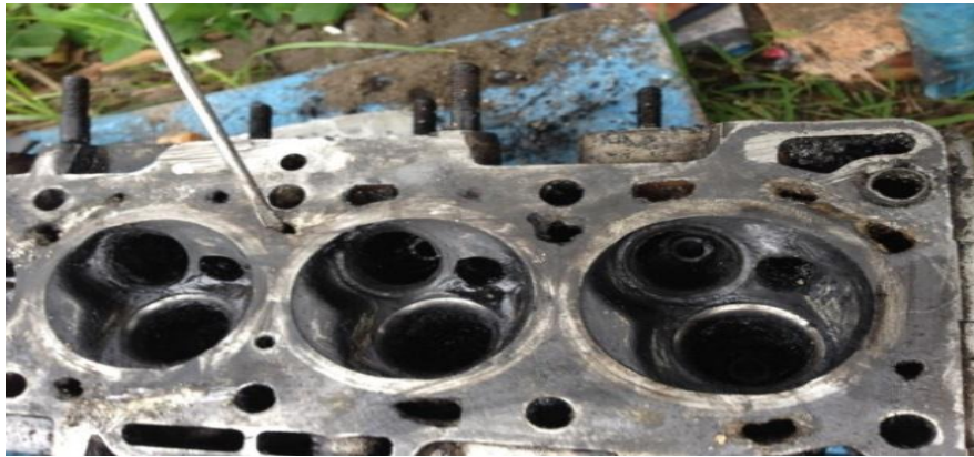
Gambar 4.2.1 Membesihkan head pada mekanisme katup.
