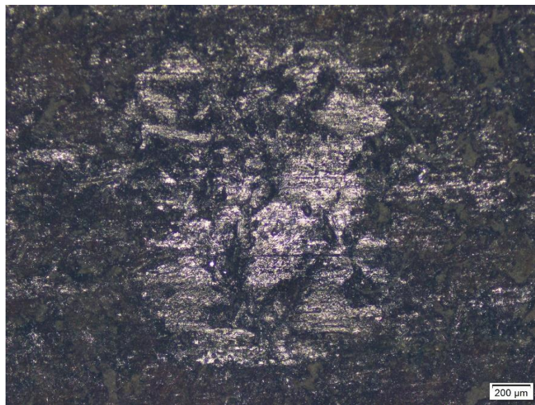
Gambar 4.3. jejak abrasi kanvas rem X dengan foto mikro.
