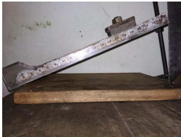
Gambar 3.28. Proses uji koefisien gesek spesimen Imitasi.
