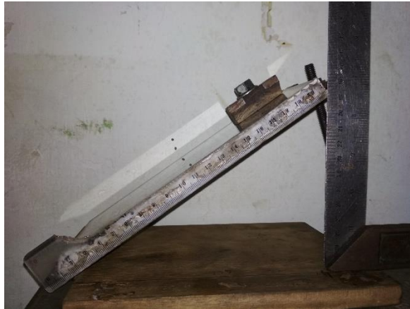
Gambar 3.27. Proses uji koefisien gesek spesimen X.
