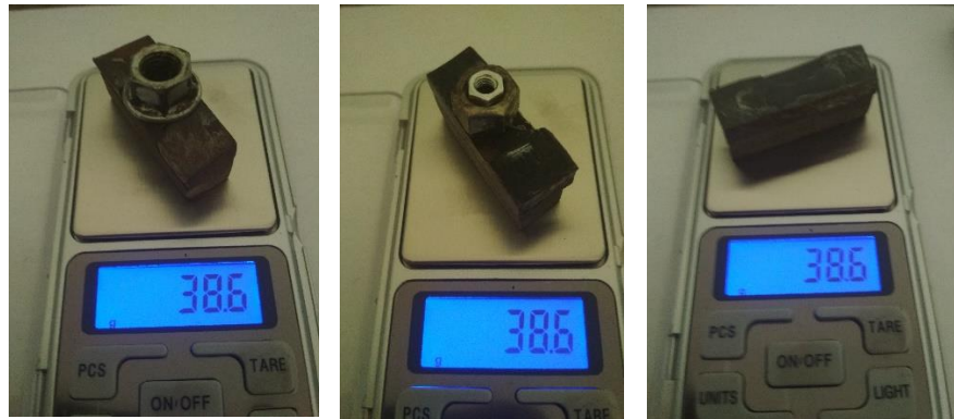
Gambar 3.26. Spesimen uji gesek (a) kampak X, (b) Imitasi, (c) Orisinil.
