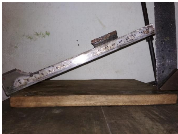
Gambar 3.29. Proses uji koefisien gesek spesimen Orisinil.
