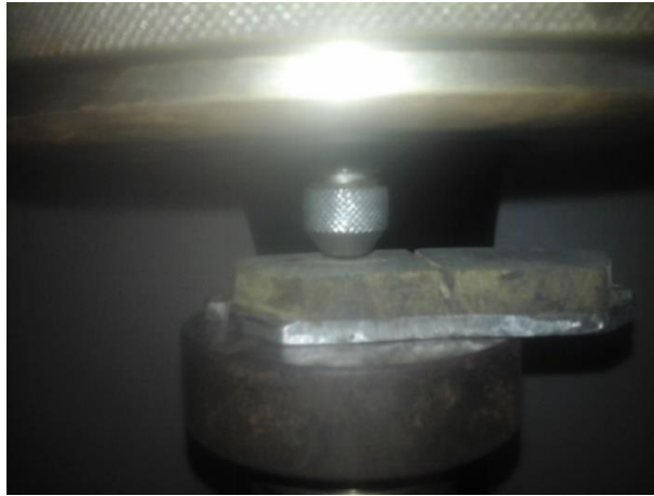
Gambar 3.25. Proses pengujian metode Brinell.
