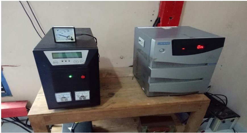
Gambar 4.12 Inverter 3,5 KW 48 V (Sumber: Dokumentasi pribadi)
