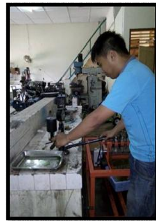
Gambar 4.2. Gambar pelaksanaan pemasangan injektor ke alat nozzle tester
