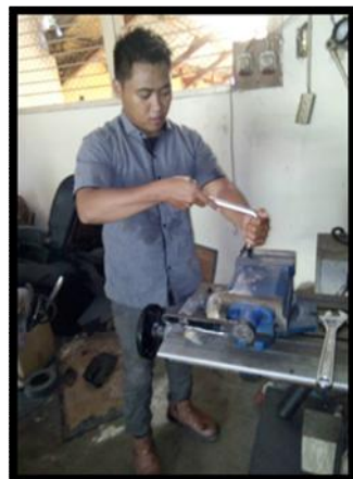
Gambar 4.7. Gambar pelaksanaan perakitan injektor
