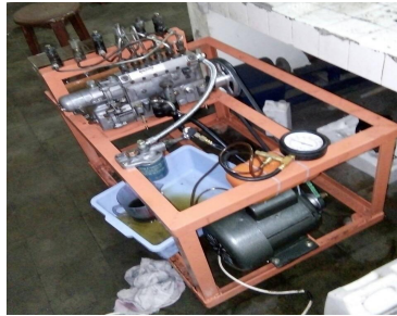
Gambar 4.1. Gambar stand pompa bahan bakar tipe in-line
