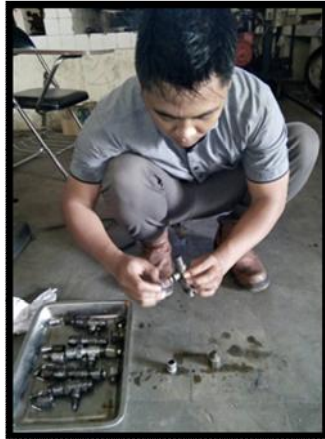
Gambar 4.6. Gambar pelaksanaan pengecekan komponen injektor
