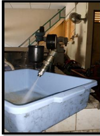
Gambar 4.4. Gambar pelaksanaan pengecekan semprotan injektor
