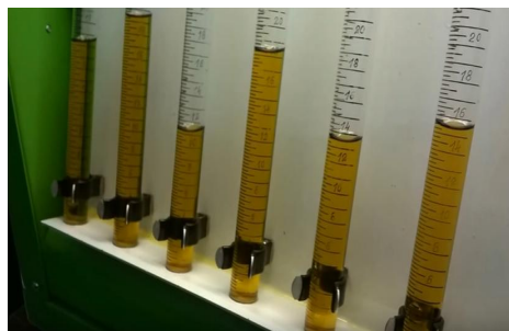
Gambar 4.2. Gambar pelaksanaan hasil kalibrasi test injection pump
