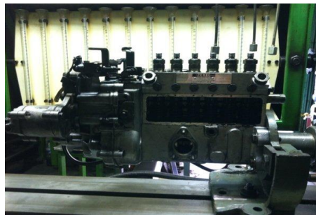
Gambar 4.9. Gambar pelaksanaan pemasangan injection pump
