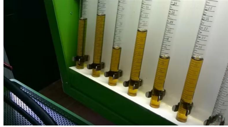
Gambar 4.10. Gambar pelaksanaan hasil penyemprotan injection pump
