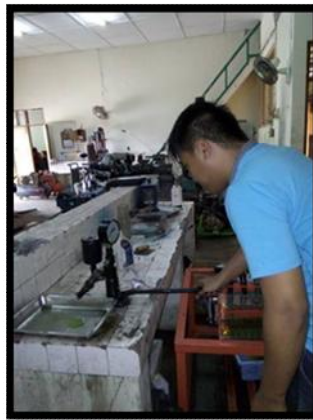
Gambar 4.3. Gambar pelaksanaan pengetesan nozzle tester
