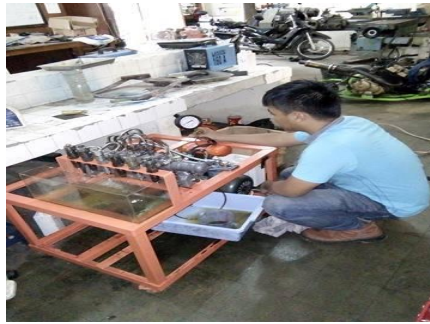
Gambar 4.8. Gambar pengukuran tekanan pompa injection pump
