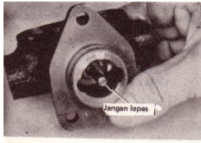
Gambar 3.19. Posisi batang pendorong
