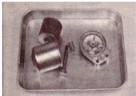
Gambar 3.28. Membersihkan bagian saringan yang dibongkar
