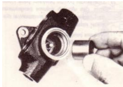
Gambar 3.20. Pemeriksaan piston pada rumah pompa
