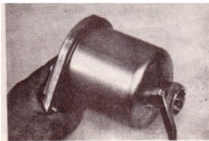
Gambar 3.32. Memasang bodi bawah dan mengencangkan bautnya
