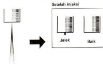
Gambar 3.41. Bentuk semprotan bahan bakar yang baik
