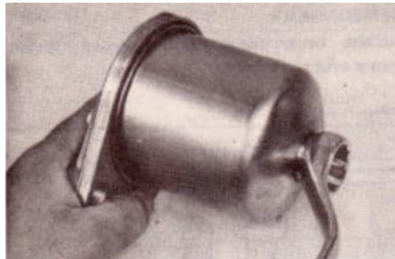
Gambar 3.27. Membuka bodi bawah saringan bahan bakar
