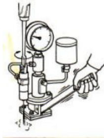
Gambar 3.39. Penyetelan tekanan pada nozzle injeksi
