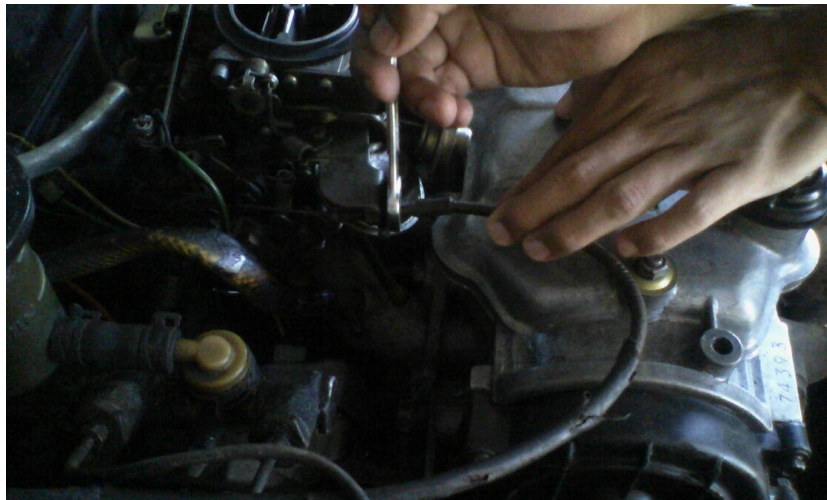
Gambar 5.2 Melepas Kabel Gas
