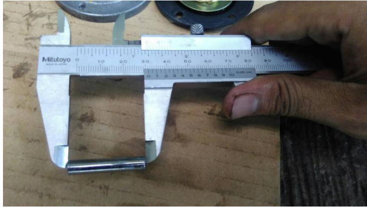
Gambar 4.2 Pengukuran panjang push rod
