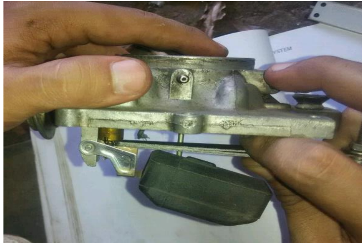
Gambar 4.6 Penyetelan pelampung posisi turun (distel menggunakan filler gauge dengan ukuran 0,8mm)
