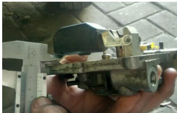
Gambar 4.7 Penyetelan pelampung posisi mengapung (distel pada ukuran 6mm)
