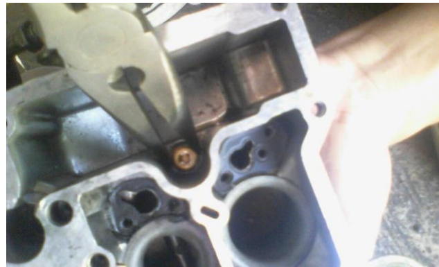
Gambar 3.20 Melepas power valve dan jet (Lepas menggunakan tang)
