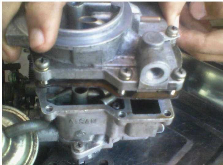
Gambar 3.9 Melepas air horn (melepas 7 baut yang mengunci ke body section dengan menggunakan obeng +)
