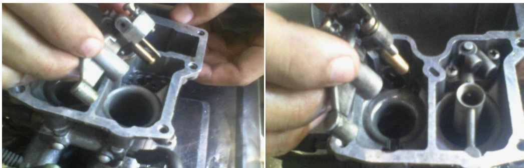
Gambar 3.18 Melepas Venturi primary dan secondary (lepas venturi primer & secundar menggunakan obeng plus)
