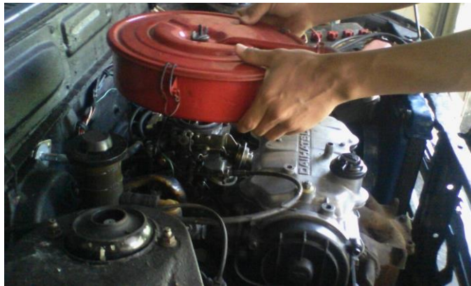
Gambar 3.1 Melepas filter udara
