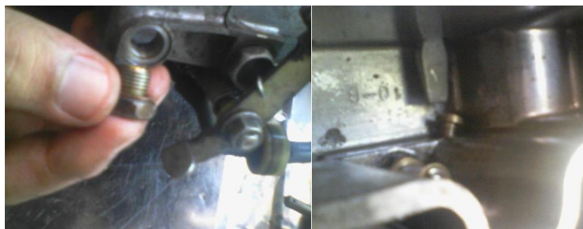
Gambar 3.21 Melepas plug & gasket dan main jet . (Lepas plug & gasket menggunakan kunci pas 12 dan lepas main jet menggunakan obeng min)
