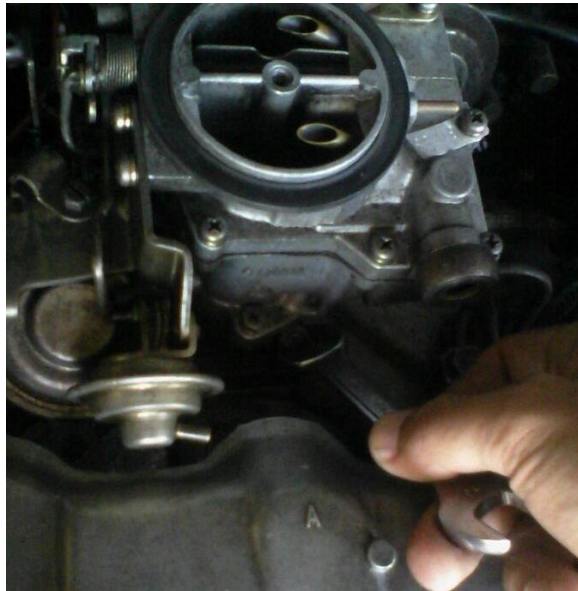
Gambar 3.4 Melepas mur pengunci karburator
