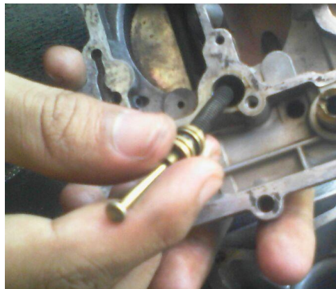
Gambar 3.14 Melepas power piston (melepas power piston dengan melepas pengunci dengan menggunakan obeng +)
