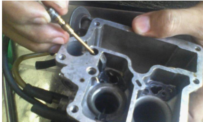
Gambar 3.19 Melepas slow jet (Lepas slow jet menggunakan tang.)
