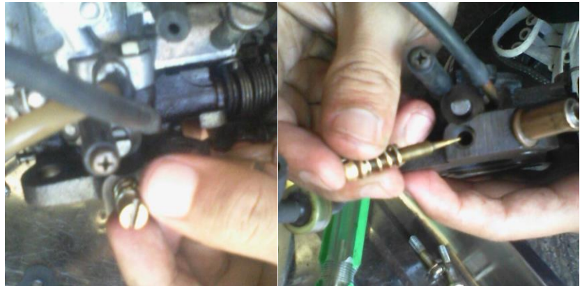
Gambar 3.23 Melepas baut penyetel campuran idle
