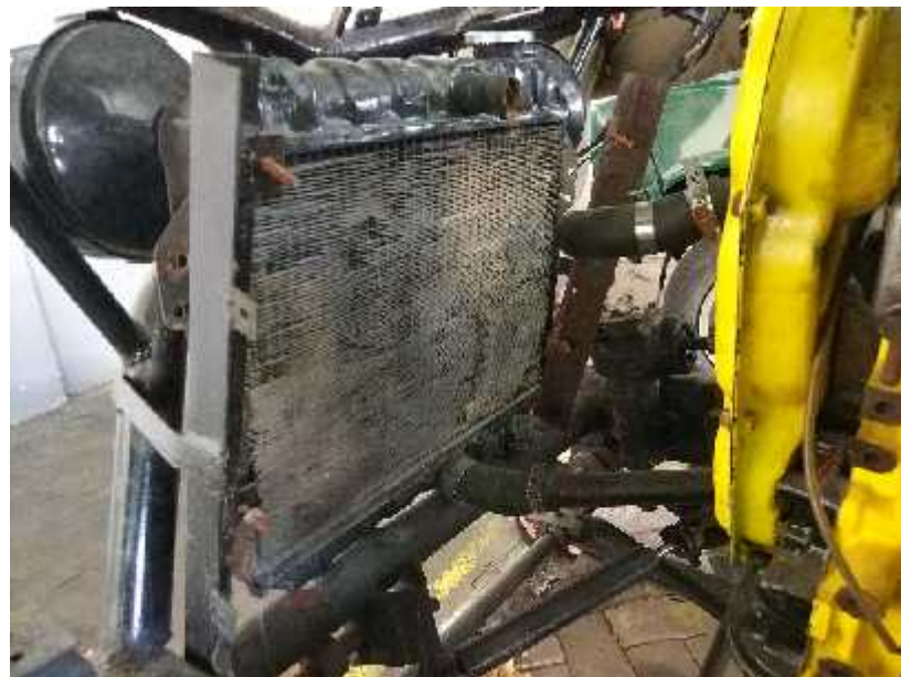
Pemasangan Radiator 3ply
