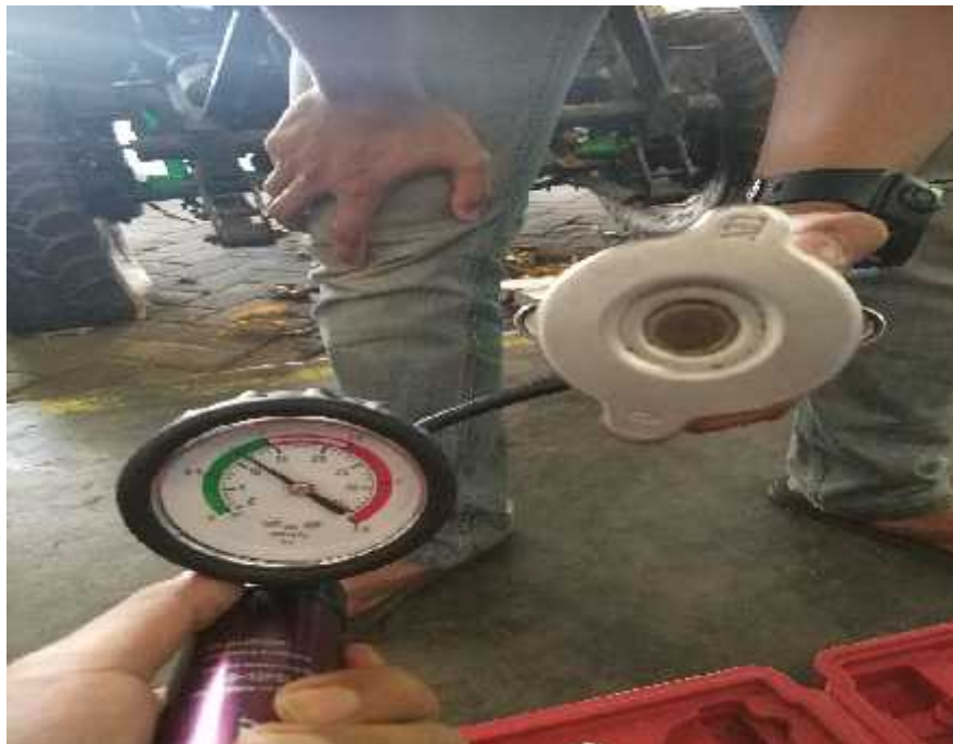
Pengecekan tekanan tutup radiator
