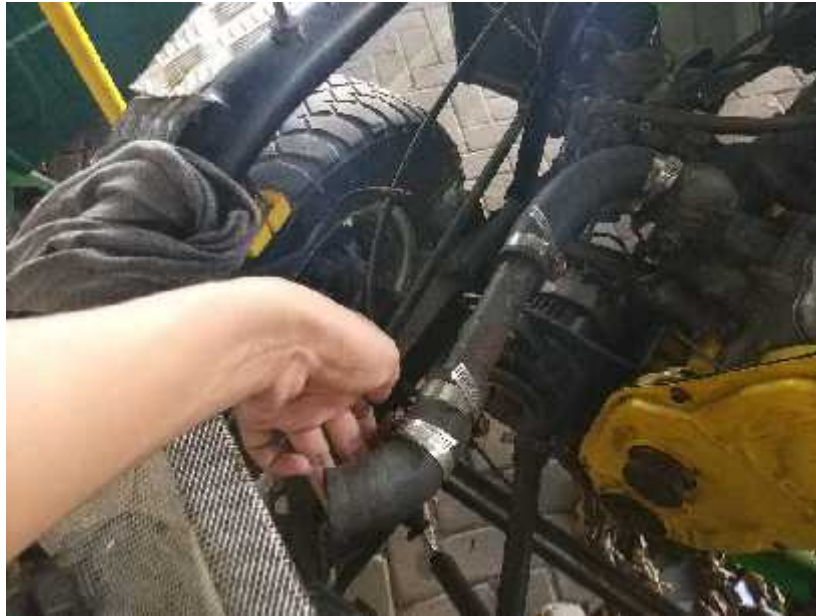
Pemasangan Selang Radiator
