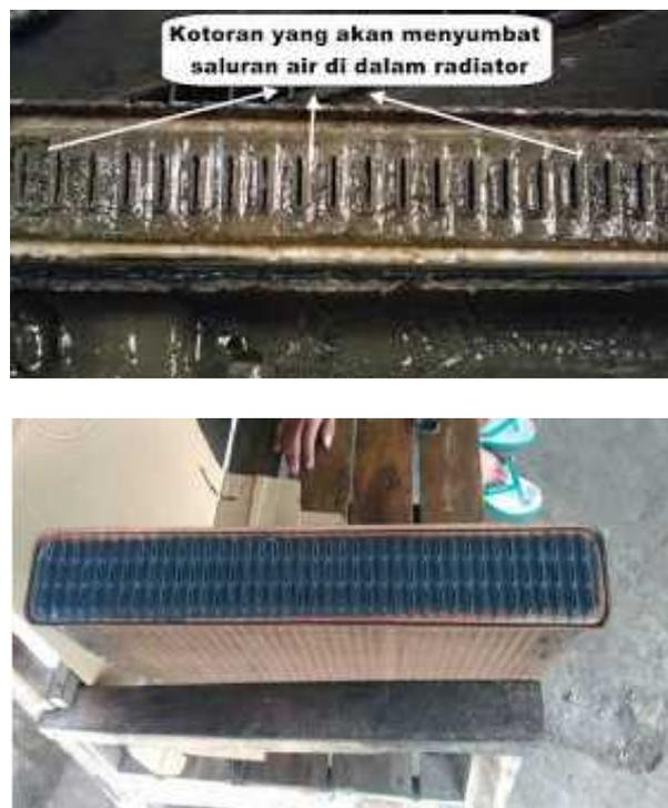
Gambar 3.10. Kondisi Radiator 2ply (atas) Radiator 3ply (bawah)
