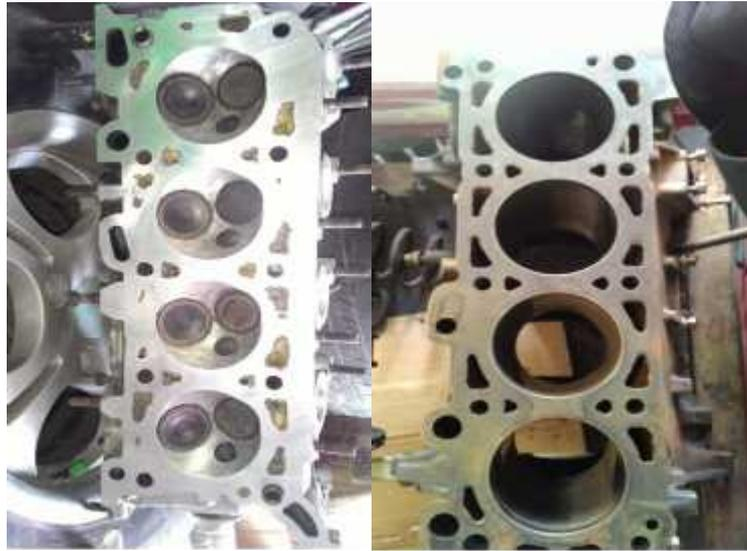
Gambar 3.13. Kondisi water Jacket di head dan blok silinder
