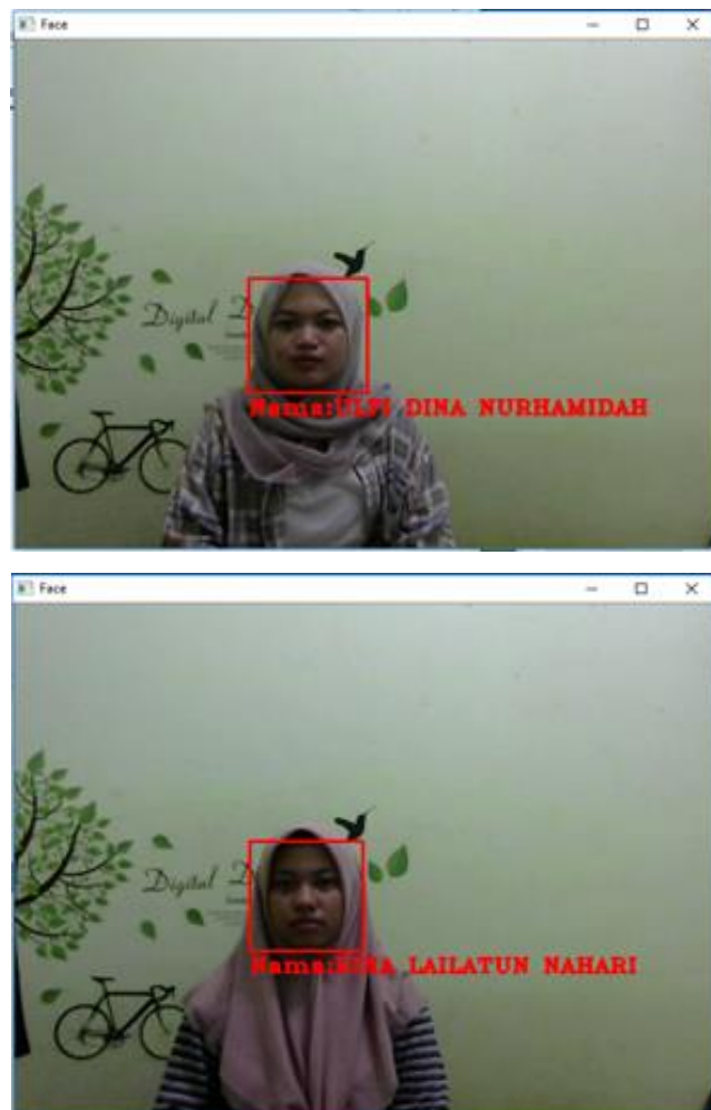
Gambar 4.26. Pengujian Pengenalan Wajah saat Jarak 160 cm
