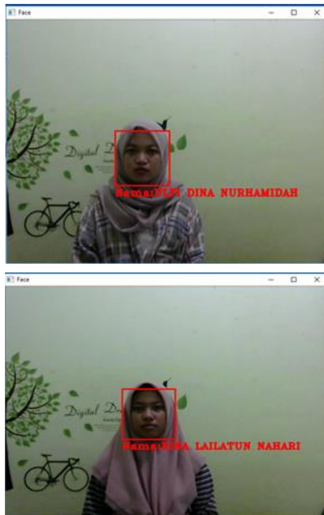
Gambar 4.25. Pengujian Pengenalan Wajah saat Jarak 150 cm
