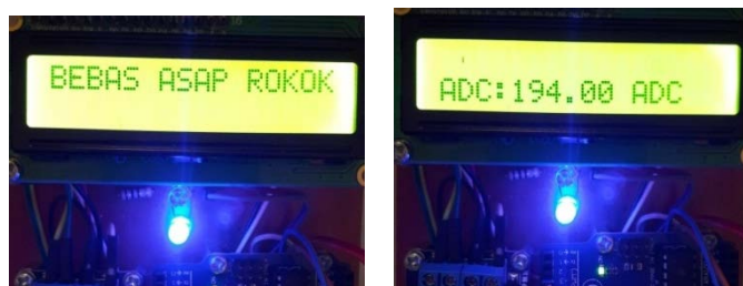
Gambar 4.8 LCD dan LED sebelum ada asap rokok
