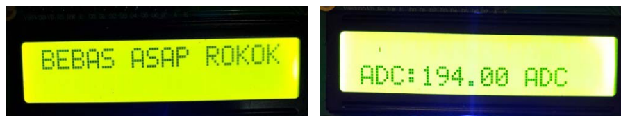
Gambar 4.6 hasil pengujian LCD pada saat tidak ada gas CO
