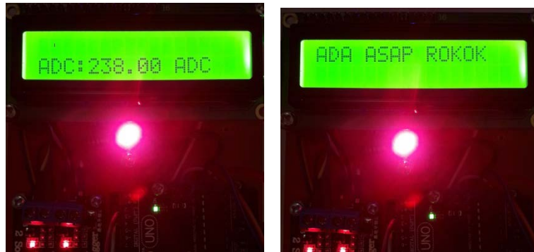
Gambar 4.9 LCD dan LED setelah ada asap rokok
