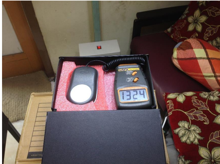
Pegujian nilai lux pada nyala lampu paling terang menggunakan alat lux meter.
