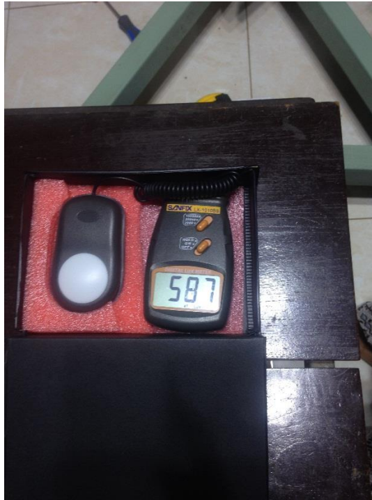
Pengujian nilai lux pada nyala lampu redup menggunakan alat lux meter.
