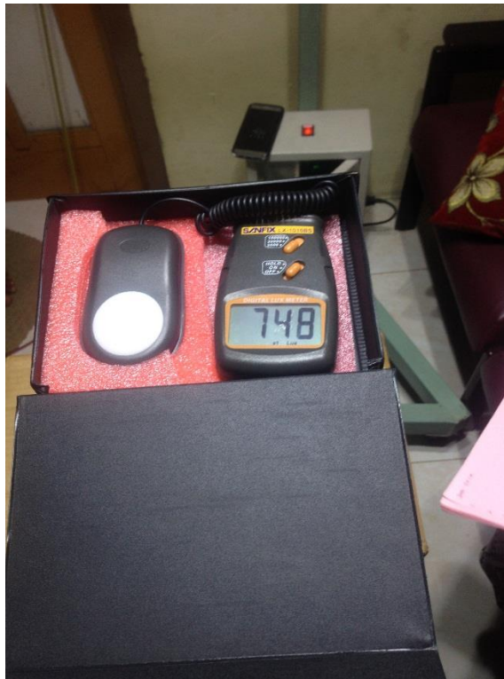
Pengujian nilai lux pada nyala lampu terang menggunakan alat lux meter.
