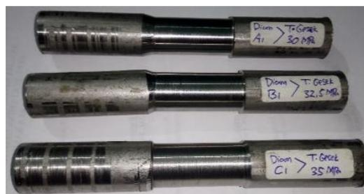
Gambar 4. Spesimen pengujian tarik
