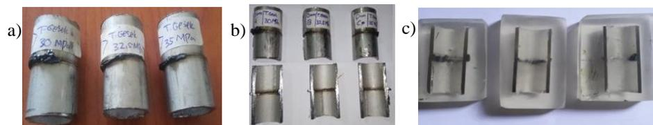
Gambar 2. (a) Hasil Potongan spesimen uji, (b) Hasil potongan melintang spesimen uji, dan (c) Hasil mounting spesimen uji.
