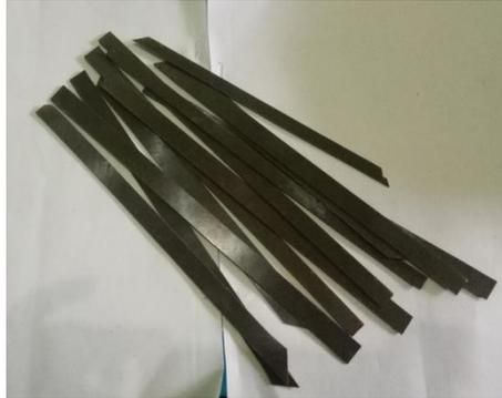
Gambar 5. Plat sudah dipotong panjang dan siap untuk dicetak
