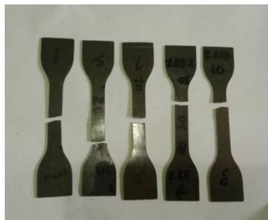
Gambar 4. Spesimen tensile setelah terjadi perpanjangan atau putusnya spesimen
