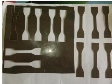
Gambar 3. Plat sudah dicetak dengan alat pencetak specimen tensile
