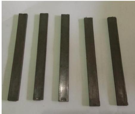
Gambar 6. Spesimen setelah melakukan proses kedua Hot Press Molding dan menjadi cetakan pengujian impact
