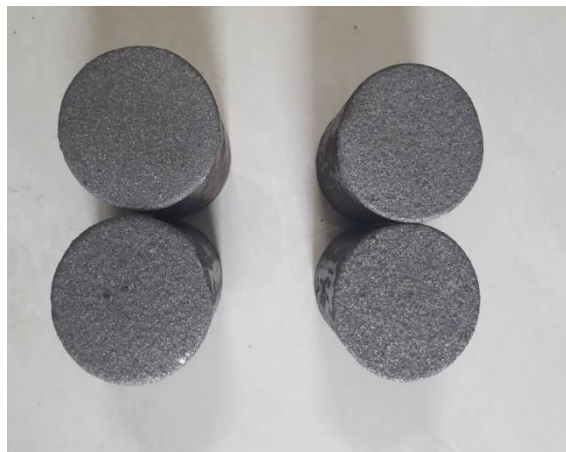
Gambar 4.3. Hasil proses thermal spray variabel tekanan udara 3 dan 5 bar, Metco sebelah kiri dan Tafa sebelah kanan.
