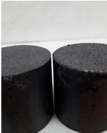
Gambar 4.5. spesimen yang memiliki lapisan coating dengan unsur paduan Ni95%Al ( bond coat ) dan unsur paduan FeSiCrNiMnBWCTiC ( top coat )
