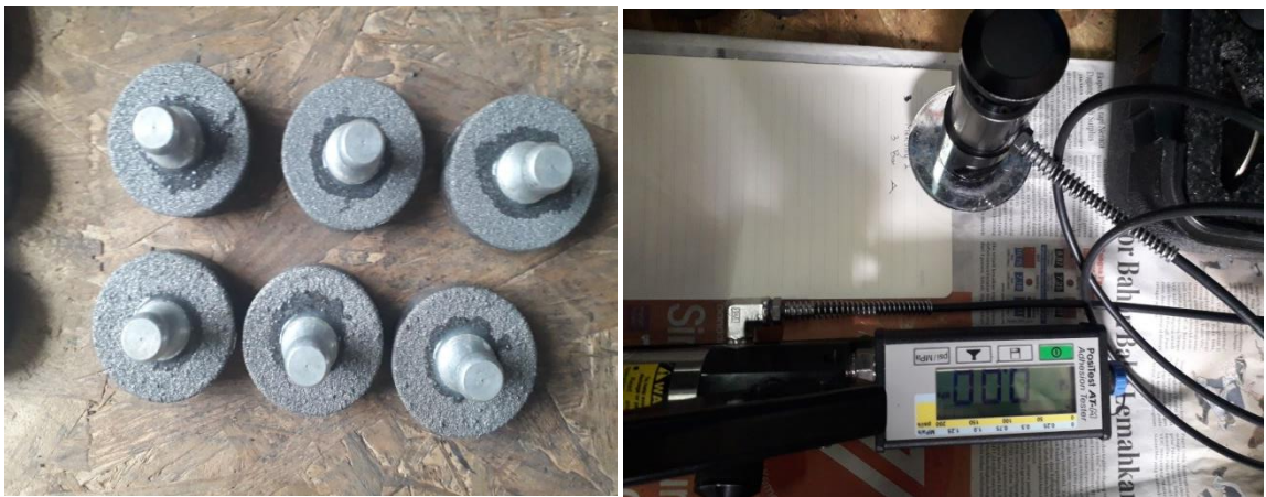
Gambar 4.5. Penempelan dolly/pin (gambar kiri) dan alat PosiTest AT-M
