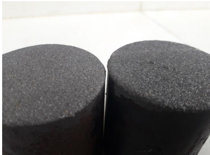
Gambar 4.4. Spesimen yang memiliki lapisan coating dengan unsur paduan Ni80%Al ( bond coat ) dan unsur paduan FeCrMnNiSi ( top coat ) dengan tekanan 5 bar sebelah kiri dan 3 bar sebelah kanan.
