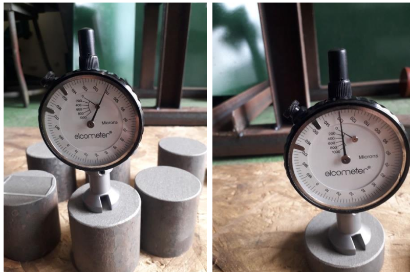
Gambar 4.2. Hasil pengukuran kekasaran spesimen dengan alat elcometer.
