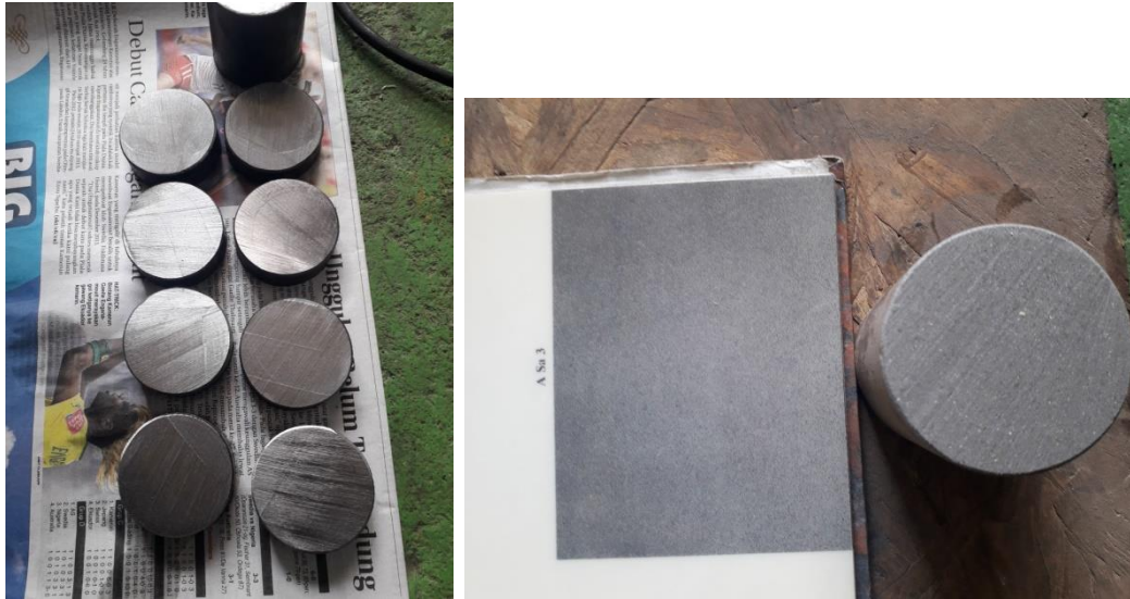
Gambar 4.1. Spesimen sebelum grit blasting (kanan) dan spesimen setelah grit blasting beserta standart A Sa 3 (kiri).
