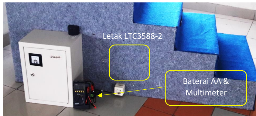
Gambar 4.23 Tata Letak Komponen Pengujian Pengisian Baterai dengan LTC3588-2
