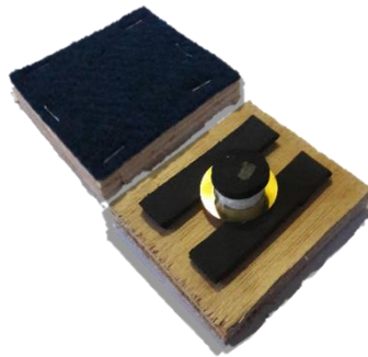
Gambar 4.1 Desain Panel Piezoelektrik yang Dipasang pada Anak Tangga Penghasil Listrik
