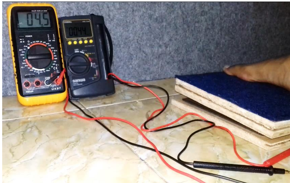
Gambar 4.5 Pengujian Panel Simulator Mini Paralel 15 Piezoelektrik dengan 2 Buah Multimeter
