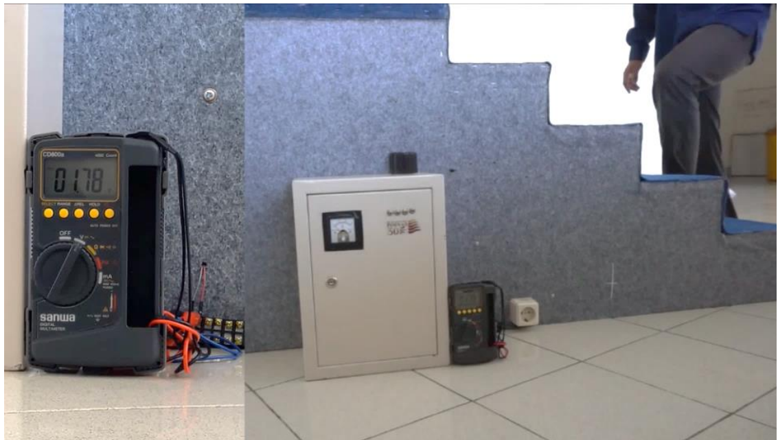
Gambar 4.23 Pengujian Pengisian Baterai dengan Tegangan Awal 1,78 V
