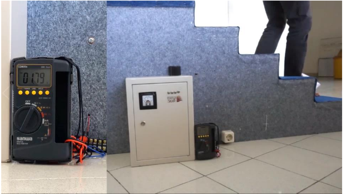
Gambar 4.24 Pengujian Pengisian Baterai dengan Tegangan Setelah Naik-Turun Tangga sebesar 1,79 V
