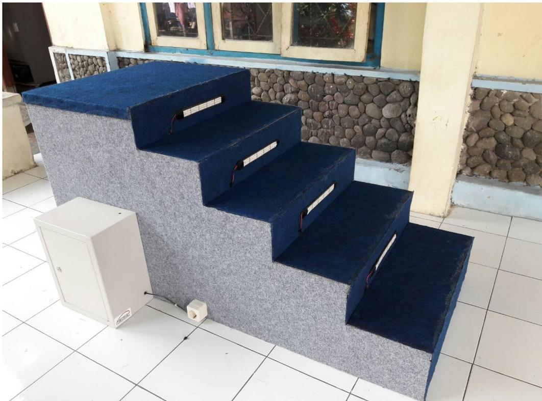
**Gambar 4.12** Tangga Penghasil Listrik berbasis Piezoelektrik
