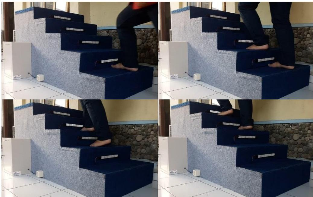
**Gambar 4.13** Tangga Pnghasil Listrik berbasis Piezoelektrik dapat Menyalakan *LED strip*
