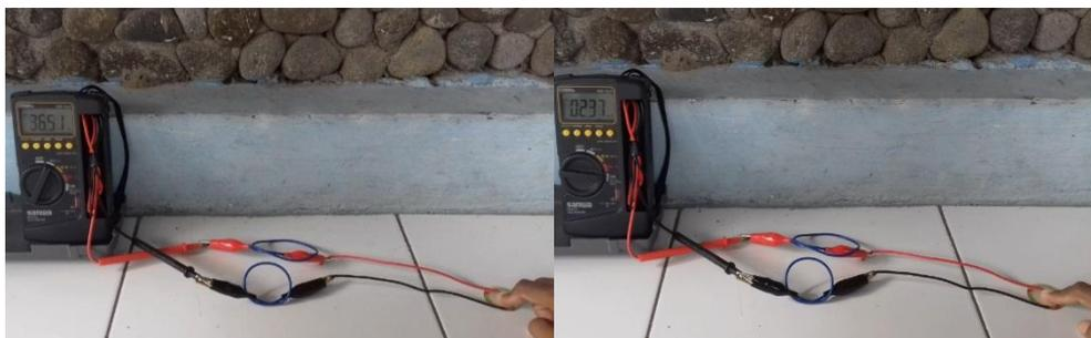
**Gambar 3.2** Pengukuran Tegangan dan Arus Desain Piezoelektrik dengan Alas Keras (Lantai)
