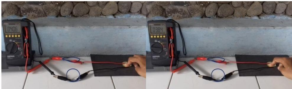
**Gambar 3.8** Pengukuran Tegangan dan Arus Desain Piezoelektrik dengan Alas Lunak (Busa Ati)
