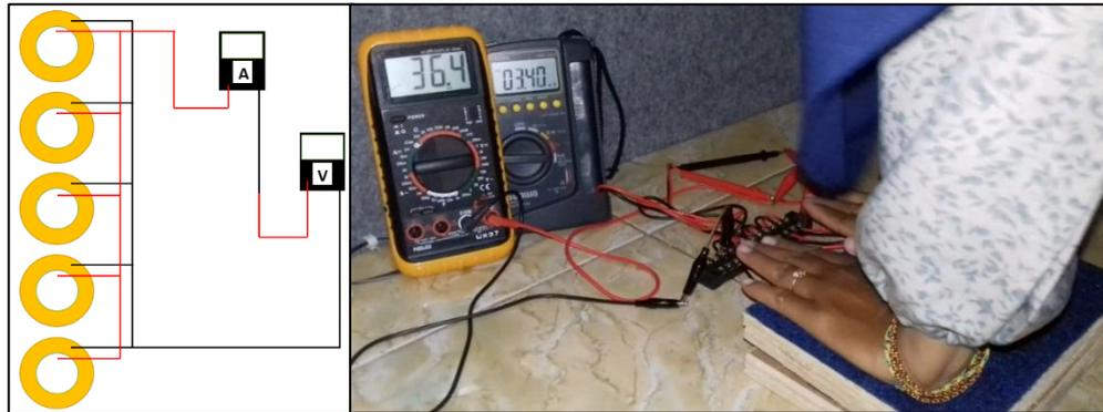
**Gambar 3.17** Skematik Rangkaian Paralel dan Pengukuran Rangkaian Paralel dengan 5 Piezoelektrik
