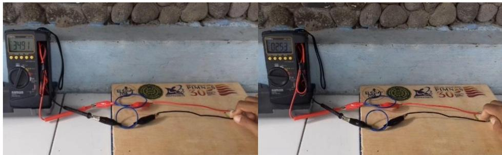
**Gambar 3.5** Pengukuran Tegangan dan Arus Desain Piezoelektrik dengan Alas Sedang (Kayu)
