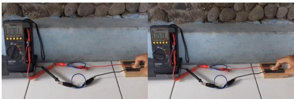
**Gambar 3.11** Pengukuran Tegangan dan Arus Desain Piezoelektrik dengan Bantalan Lunak
