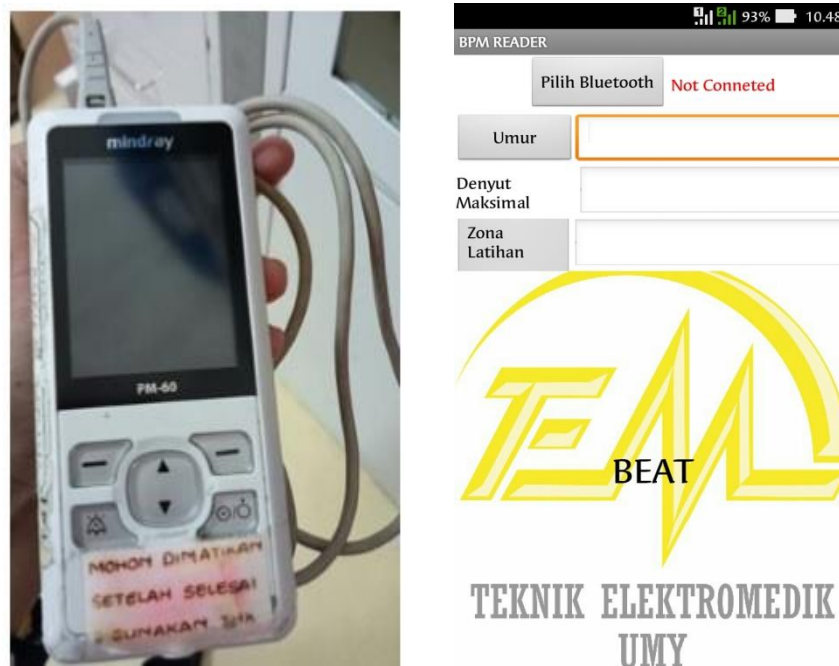
Gambar 4.1 Pulse Oxymeter dan aplikasi android BPM_Reader
