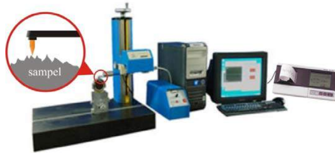
Gambar 2.5 Skema stylus membaca permukaan sampel (Hidayat 2013)
