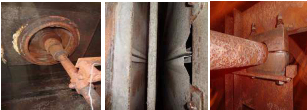
4.2 Korosi pada komponen ESP (a) Anoda discharge, (b) pelat pengumpul, (c) Poros dan bantalan hammer (Sepfitrah, dkk. 2015)
