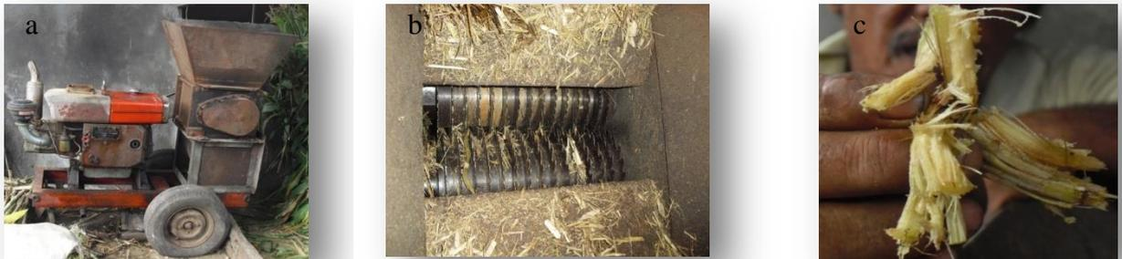
Gambar 2. Mesin pencacah limbah pertanian (a) yang dimodifikasi pada bagian pisau (b) dan hasil cacahan (c)
