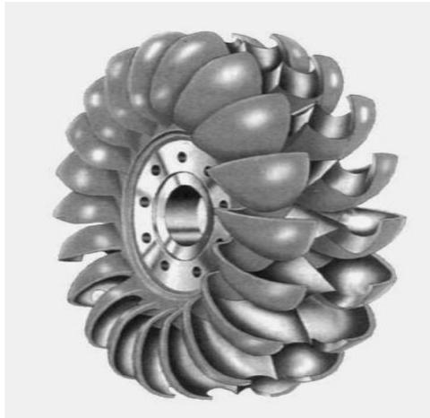
Gambar 2.10 Bentuk *Runner* dari Turbin impulse (Pelton).
