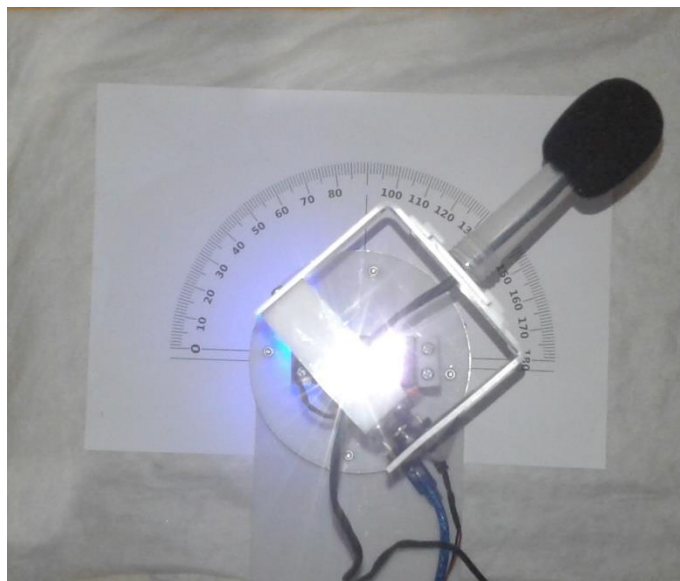
Gambar 4. 10 Uji coba servo sudut 135°
