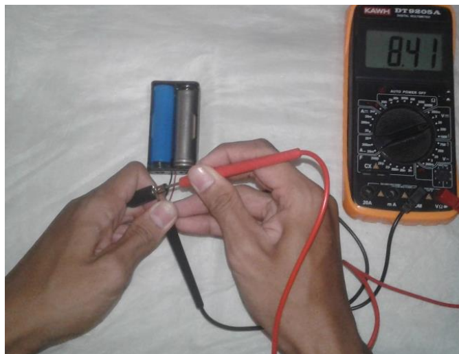
Gambar 4. 2 Pengukuran tegangan baterai dirangkai seri
