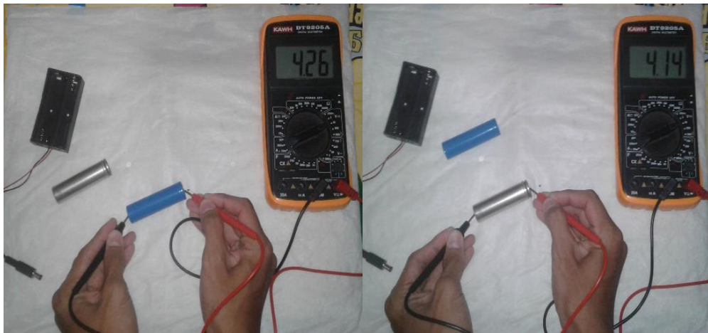
Gambar 4. 1 Pengukuran tegangan baterai 1 sel
