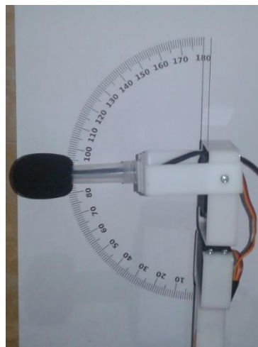
Gambar 4. 12 Uji coba servo sudut 90 0
