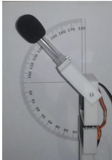
Gambar 4. 13 Uji coba servo sudut 145°
