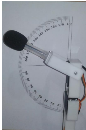
Gambar 4. 11 Uji coba servo sudut 112 0
