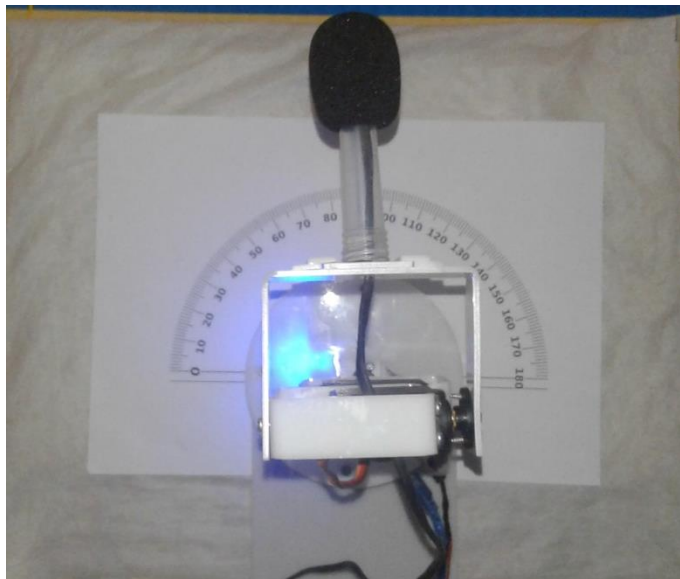
Gambar 4. 8 Uji coba servo sudut 90°
