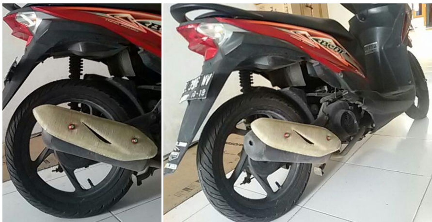
Gambar 4.9 Pemasangan cover pada kendaraan
