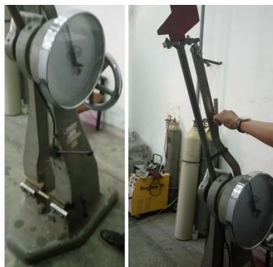
Gambar 3.42 Proses pengujian impact
