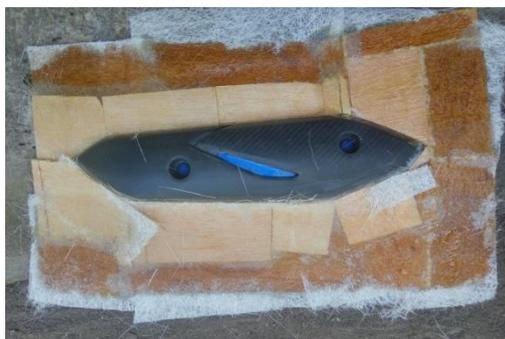
Gambar 3.45 Penguatan mold dengan *hand lay up*
