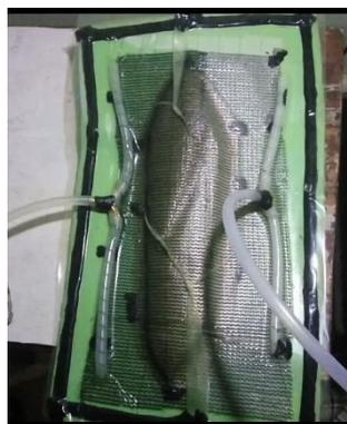
Gambar 3.52 Proses pengaliraaan resin kedalam cetakan
