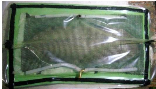
Gambar 3.51 Merangkai sistem saluran masuk dan keluar pada cetakan
