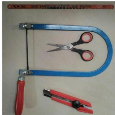
Gambar 3.12 Alat pemotong spesimen
