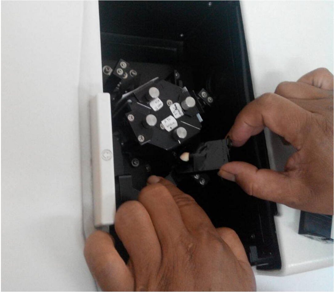
Gambar 8 Gigi diuji dengan specthropotometer
