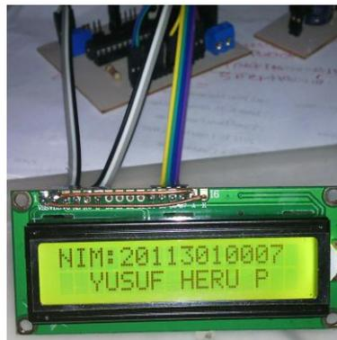
Gambar 3.48. Perangkat Keras *Liquid Crystal Display (LCD)*
