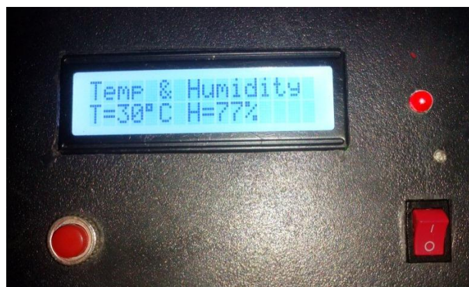
Gambar 4.4. Tampilan Alat Pada Saat Buzzer Berbunyi Dan Led Warning Menyala.
