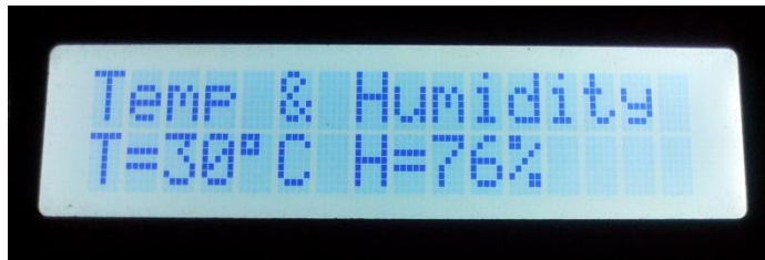
Gambar 4.3. Tampilan LCD Saat Menampilkan Suhu Dan Kelembaban.
