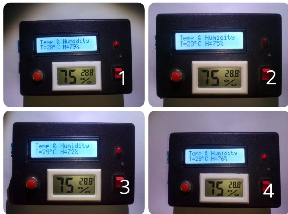
Gambar 4.9. Empat Perbandingan Suhu Alat Dengan Thermometer hygrometer digital .
