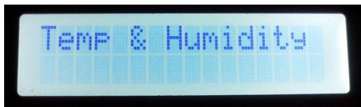
Gambar 4.2. Tampilan LCD Sebelum Menampilkan Suhu Dan Kelembaban.
