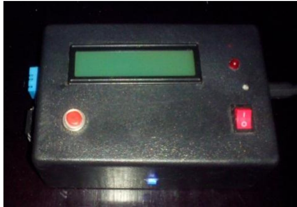
Gambar 4.6. Tampilan LED Pengisian Penuh Pada Saat Alat Posisi Off .
