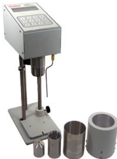
Gambar 2.7. Viskometer Cup dan Bob
