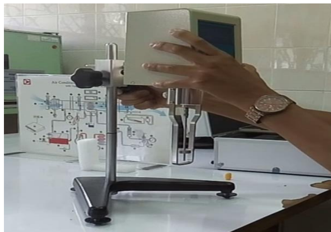
Gambar 3.15. Pemasangan viskometer pada penyangga
