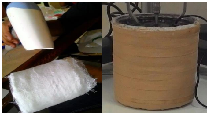
Gambar 3.22. Proses pembuatan dan hasil gelas dengan isolator
