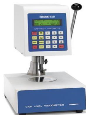
**Gambar 2.9.** Viskometer *Cone* dan *Plate*
