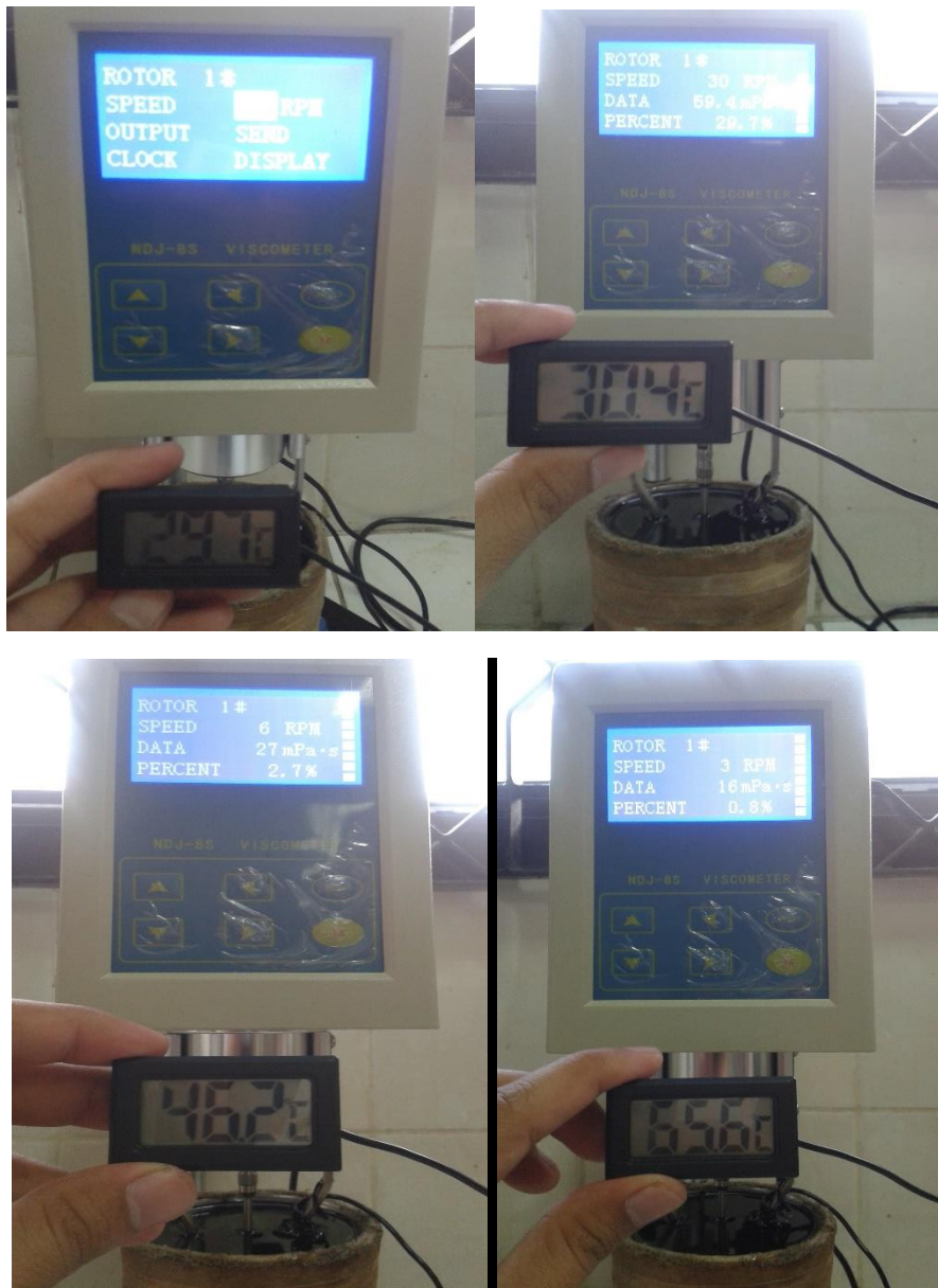
Pengujian viskositas dengan variasi temperatur suhu
