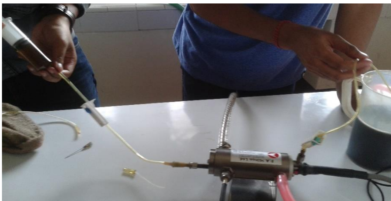
Proses memasukkan sampel oli pada alat konduktivitas termal
