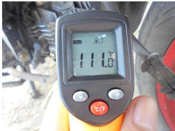
Gambar 4.8 Hasil pengukuran temperatur mesin
