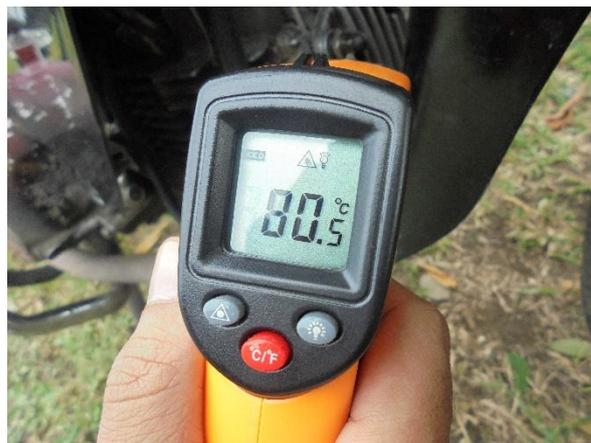
**Gambar 4.9** Hasil pengukuran temperatur mesin
