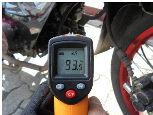
**Gambar 4.11** Hasil pengukuran temperatur mesin
