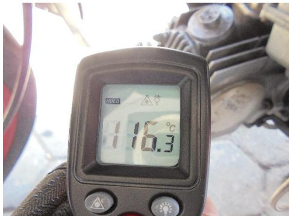
Gambar 4.12 Hasil pengukuran temperatur mesin
