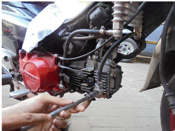
**Gambar 4.2** Pemasangan baut nepel dan selang pada tutup silinder head sebelah kanan
