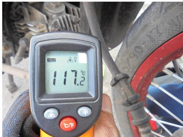
Gambar 4.10 Hasil pengukuran temperatur mesin
