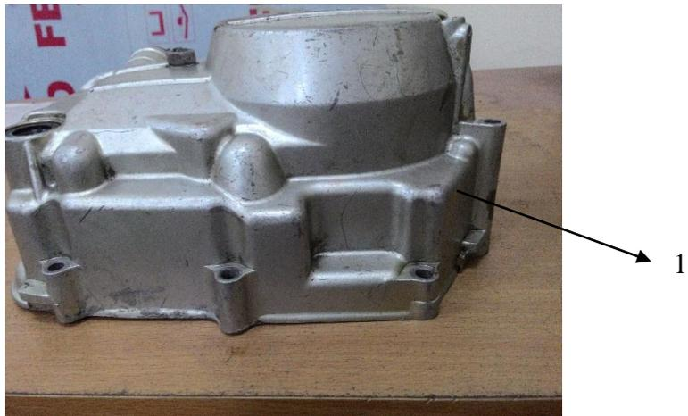
**Gambar 3.2** posisi yang akan dibuat lubang pada bak koping
