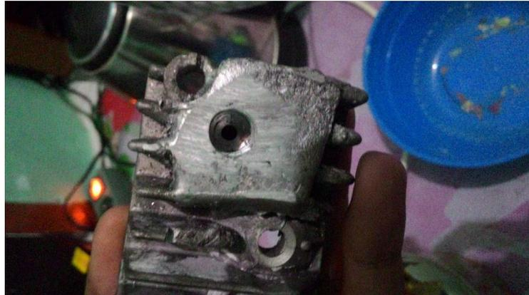
**Gambar 3.6** tutup silinder setelah dilubangi
