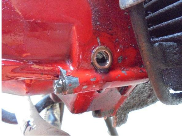
**Gambar 3.4** Bak kopling setelah dilubangi
