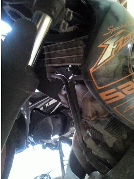
**Gambar 2.4** gambar mesin dengan pendingin *oil cooler*
