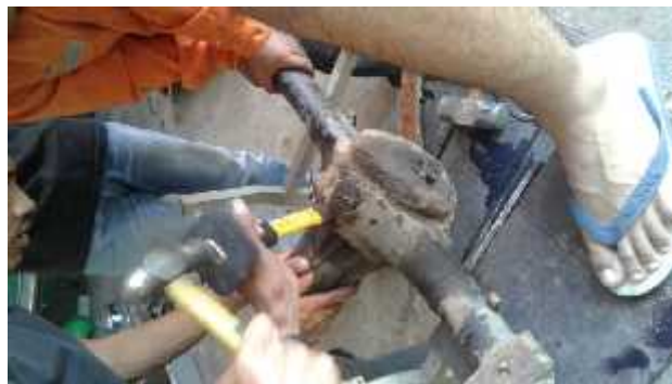
Gambar 4. 4 Melepas poros penggerak dengan differential .
