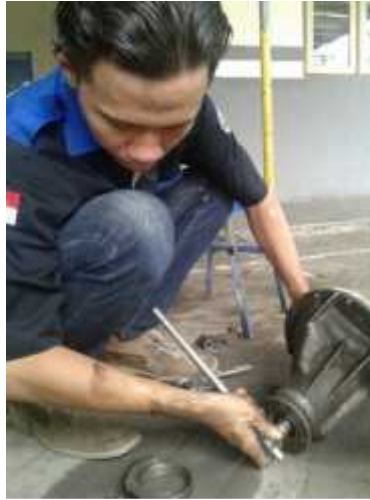
Gambar 4.14 Pemasangan drive pinion ke rumah gardan.
