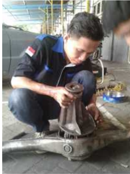
Gambar 4.17 Pemasangan dan penyetelan gardan ke rear axle housing .
