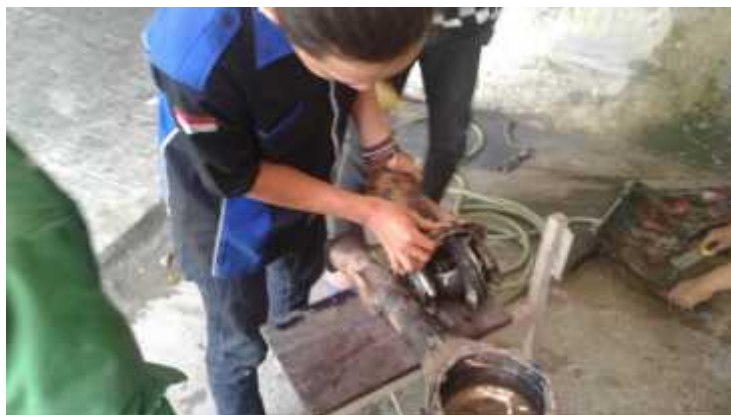
Gambar 4.5 Lepasnya poros penggerak dan differential .
