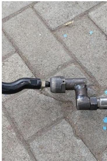
Gambar 4.9 Penghubung *Rack And Pinion* dengan *Long Tie Rod*
