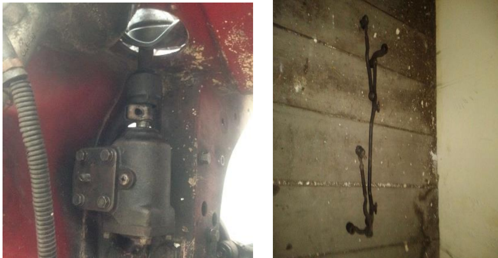
Gambar 3.12 Sistem Kemudi Recirculating Ball
