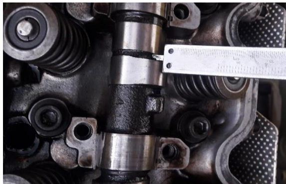
Gambar 4.4 Pengukuran Ketinggian Lift Camshaft
