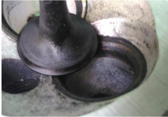
Gambar 4.3 Pengecekan Kondisi Katup Yang Berkerak
