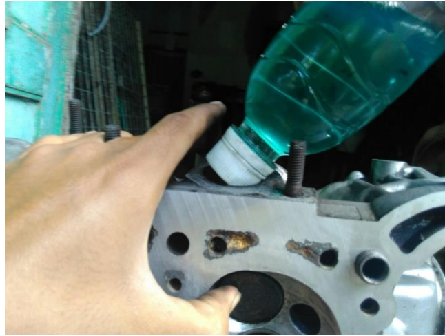
Gambar 4.8 Memeriksa Kebocoran Katup
