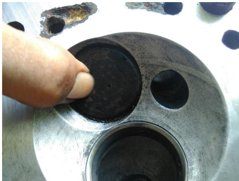
Gambar 4.13 Kondisi Katup Rapat Tidak Terdapat Kebocoran
