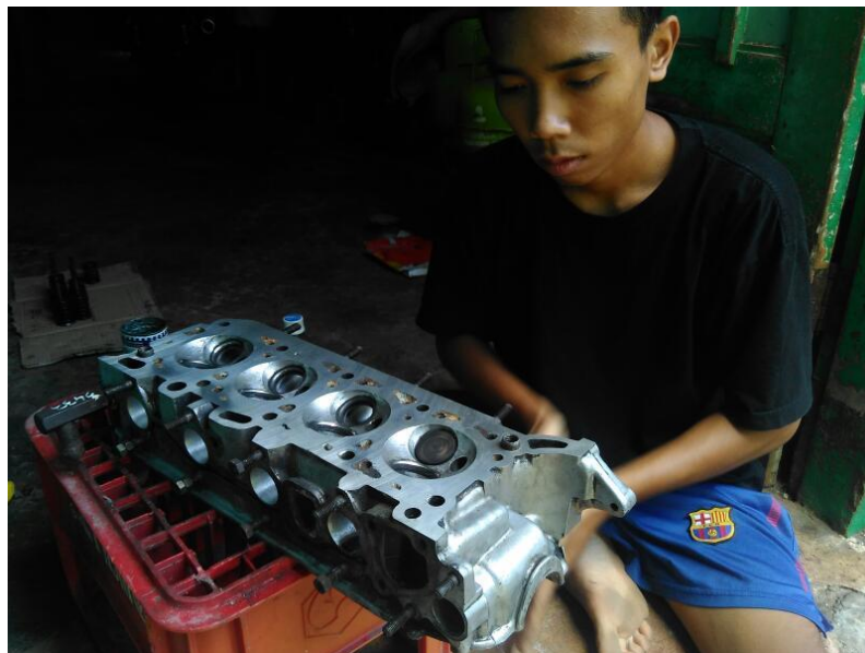
Gambar 4.7 Proses Penyekuran Katup
