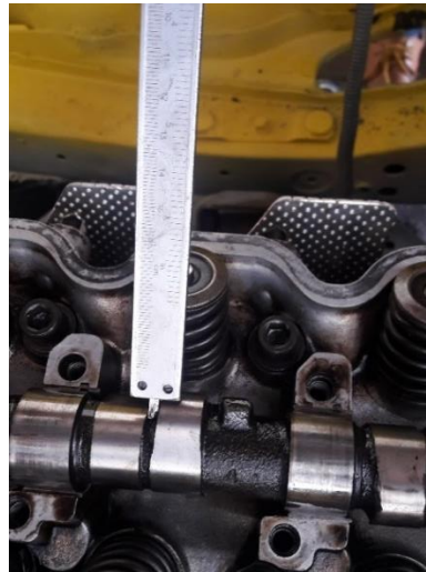
Gambar 4.14 Pengukuran Ketinggian Lift Camshaft
