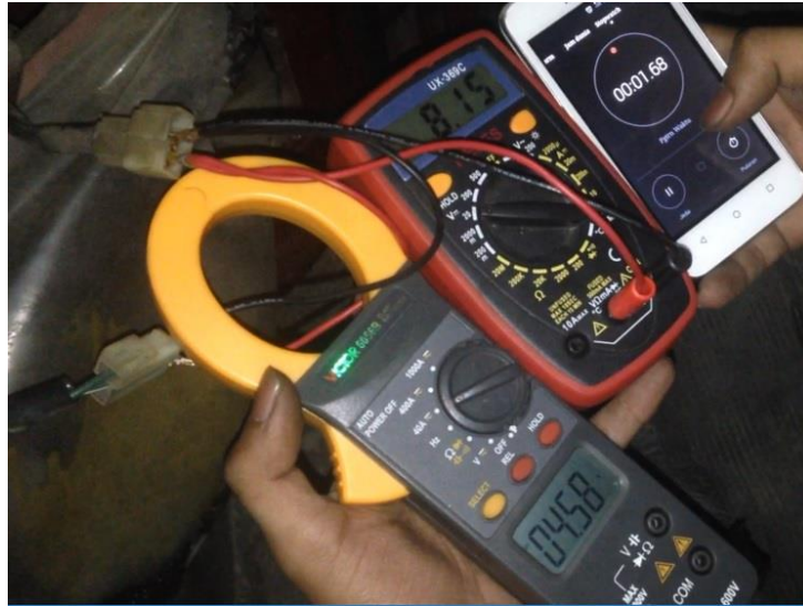
Gambar 4.4 Pengukuran tegangan dan kuat arus pada power window tanpa kapasitor bank
