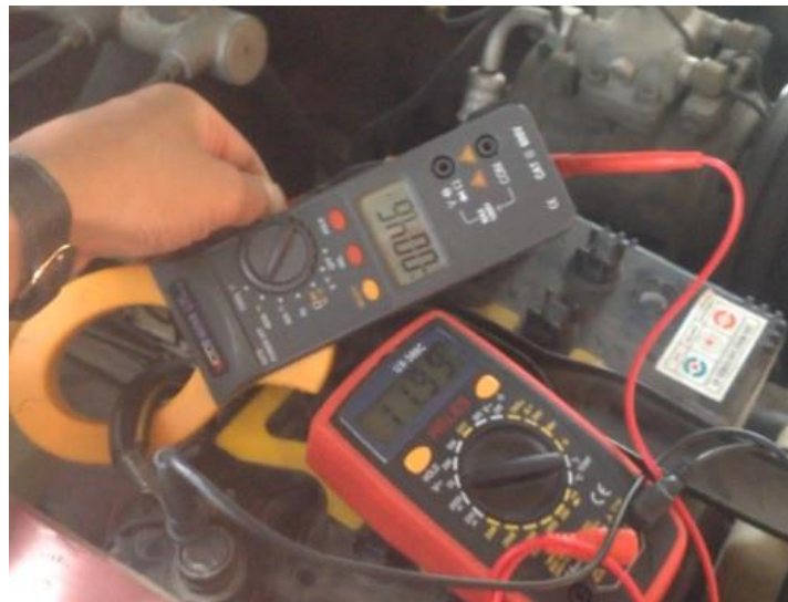
Gambar 4.5 Pengukuran Sistem Pengisian Tanpa Kapasitor Bank
