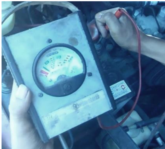
Gambar 4.1 Pengukuran kondisi baterai
