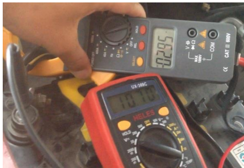
Gambar 4.10 Pengukuran Sistem Motor Starter Menggunakan Kapasitor Bank
