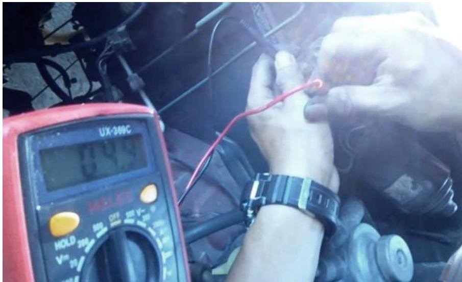
Gambar 4.2 Pengukuran tahanan komponen sistem kelistrikan mobil isuzu panther
