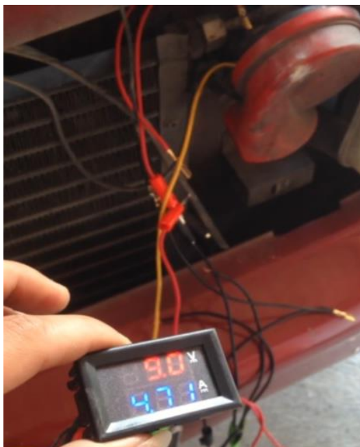
Gambar 4.3 Pengukuran tegangan dan kuat arus pada klakson tanpa kapasitor bank
