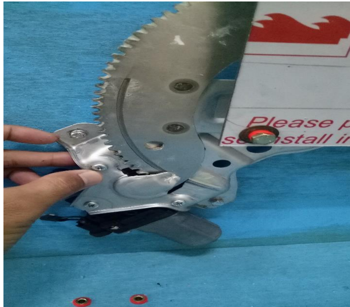
Gambar 4.2 pemasangan motor dan regulator power window
