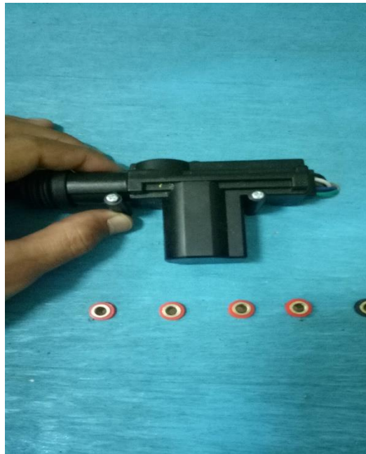
Gambar 4.7 pemasangan motor central lock
