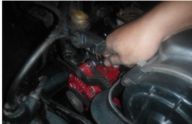
Gambar 3.14 Mengendorkan setelan altenator
