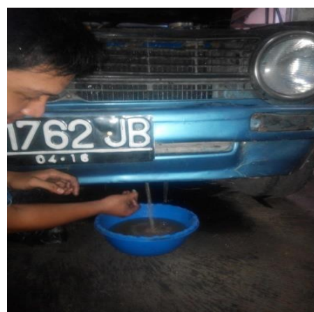
Gambar 3.2 Mengeluarkan air radiator
