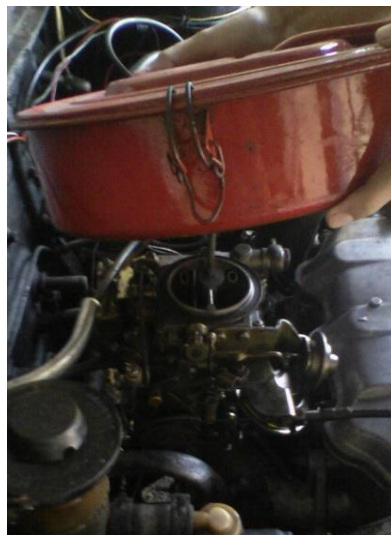
Gambar 3.8 Melepas saringan udara
