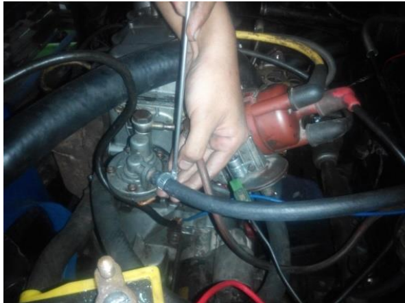
Gambar 3.6 Melepas selang pompa bahan bakar
