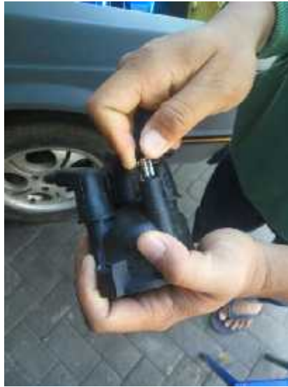
Gambar 4.11 Penggantian Tutup Distributor
