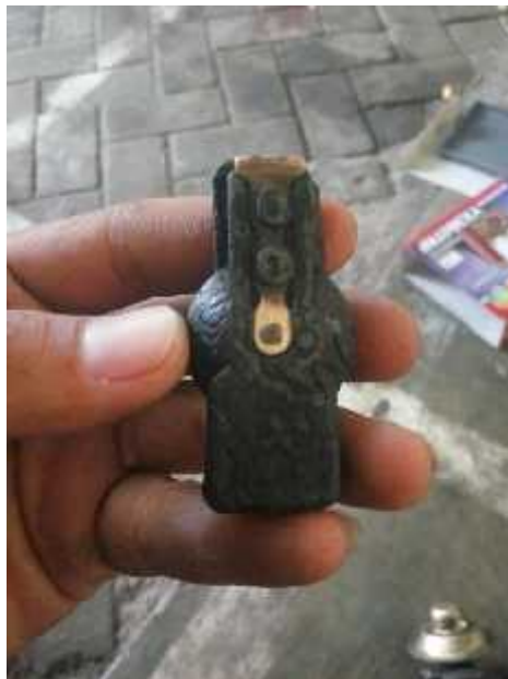
Gambar 4.3 Pemeriksaan Rotor Distributor
