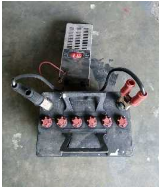
Gambar 4.5 Pemeriksaan Baterai Dengan Menggunakan Baterai Tester
