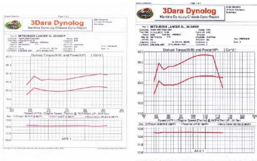
Gambar 4.19 Diagram dynotest sebelum dan sesudah dilakukan development
