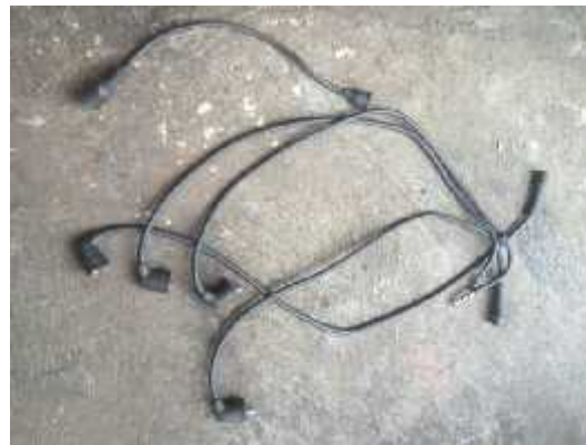
Gambar 4.9 Kabel tegangan tinggi2
