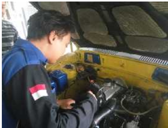
Gambar 4.17 Proses pemeriksaan dan penyetelan waktu pengapian
