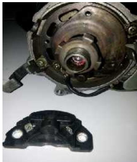
Gambar 4.4 Pemeriksaan terminal yang ada pada transistor Unit
