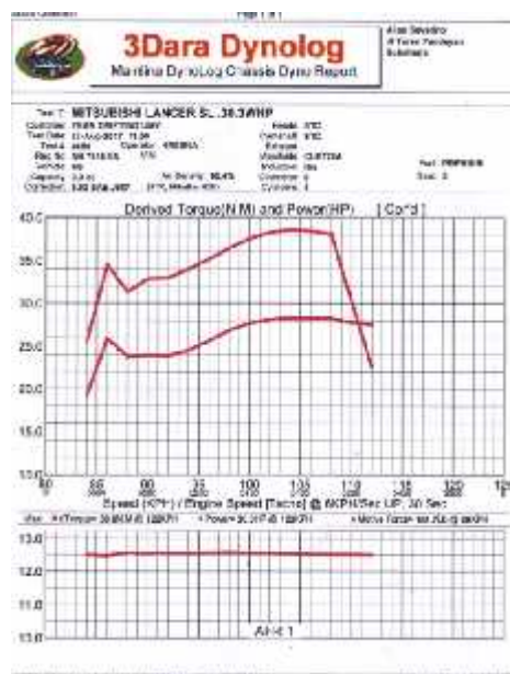
Gambar 4.18 Hasil dynotest setelah dilakukan development
