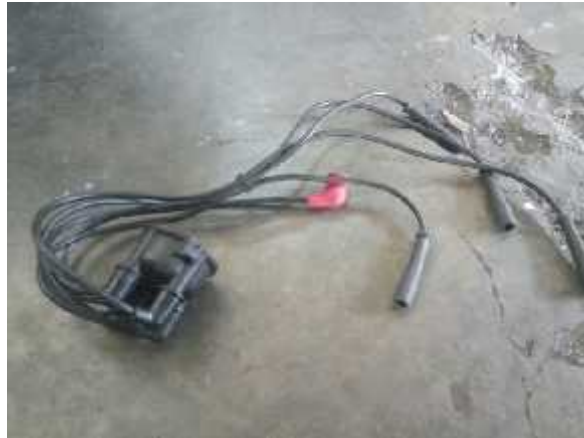
Gambar 4.14 Pengantian kabel tegangan tinggi busi
