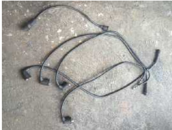
Gambar 3.10 Kabel Tegangan Tinggi
